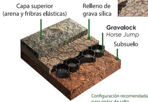
Se debe compactar el terreno con máquina o manualmente con pisón. Se coloca la grava de base, nivelada y las rejillas se instalan a mano. Se cortan con esmeril o sierra para dar forma a las terminaciones irregulares en el terreno en los extremos. Se recomienda una buena planeación antes de ensamblar las rejillas.
